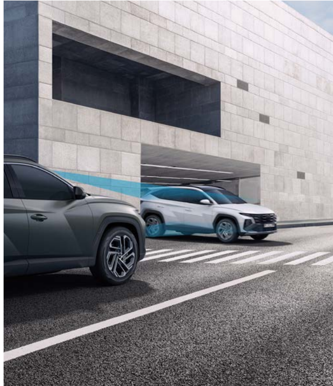
Forward Collision-avoidance Assist with Junction Turning (FCA-JT)* Fitur ini memperingatkan pengemudi ketika sistem mendeteksi ada risiko benturan dari arah depan atau saat ingin berbelok ke kanan, seperti misalnya dengan pejalan kaki atau dengan kendaraan yang tiba-tiba melambat atau berhenti.
