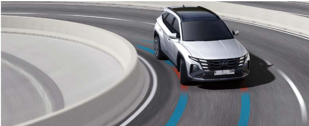
e-Dynamic Drive Mengurangi understeer melalui pengaturan kontrol rem saat kendaraan menikung.
