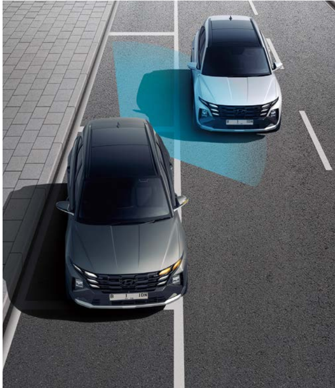
Blind-spot Collision-avoidance Assist (BCA)* Memonitor blind-spot Anda saat berkendara. Bila ada kendaraan lain yang terdeteksi di sekitar mobil Anda, LED pada kaca spion akan menyala memberikan peringatan. Jika ada risiko benturan dengan kendaraan di sisi samping dalam kecepatan rendah (0-3 km/jam), seperti misalnya saat keluar dari posisi parkir paralel, sistem akan berfungsi secara otomatis membantu pengereman darurat.
