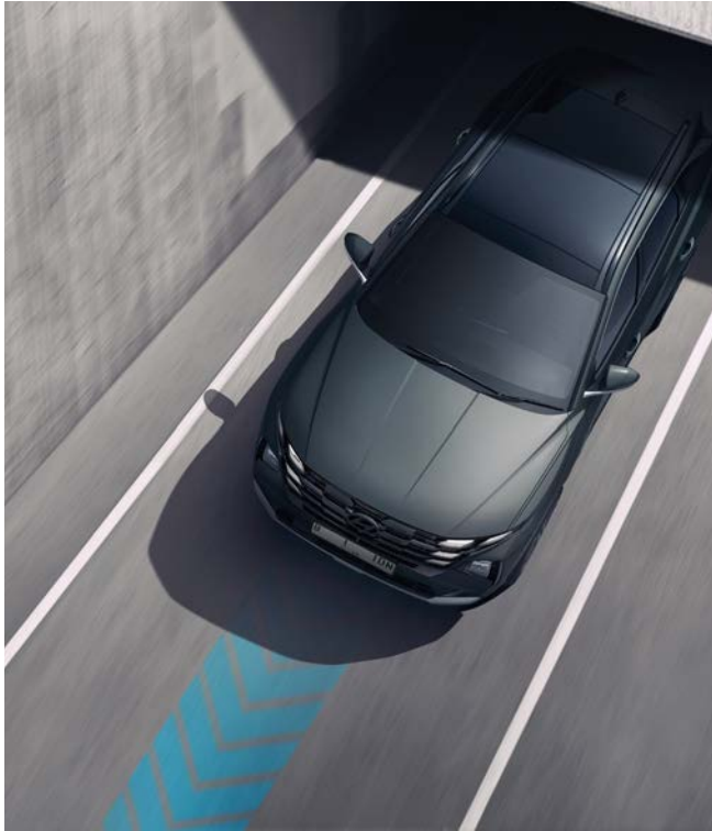
Lane Following Assist (LFA)* Kamera depan melacak penanda garis jalur dan membantu pengemudi untuk tetap menjaga kendaraan agar tetap aman di tengah jalur.
