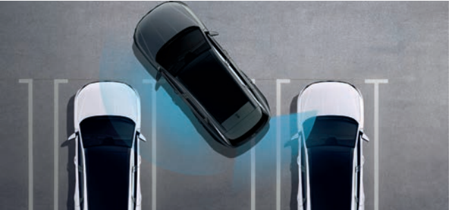
Forward/Side/Reverse Parking Distance Warning (PDW)* Memberikan peringatan terhadap kemungkinan benturan dengan objek di sekitar kendaraan pada kecepatan rendah.
