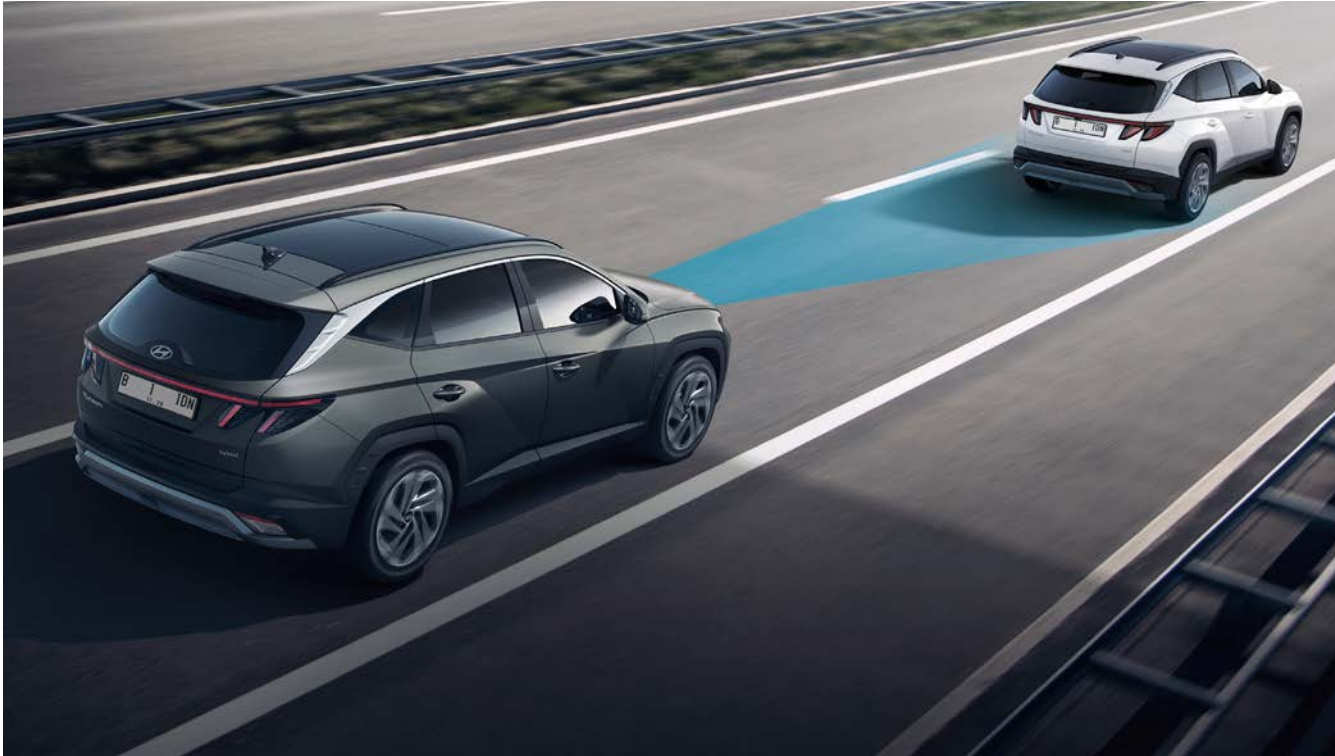
Smart Cruise Control with Stop & Go (SCC w/ S&G)* Mengatur kecepatan kendaraan tanpa harus menginjak pedal gas yang secara otomatis dapat menyesuaikan jarak kendaraan di depannya. Apabila kendaraan di depan berhenti, SCC akan secara otomatis mengurangi kecepatan sampai berhenti, dan akan kembali melaju mengikuti kendaraan di depan.
