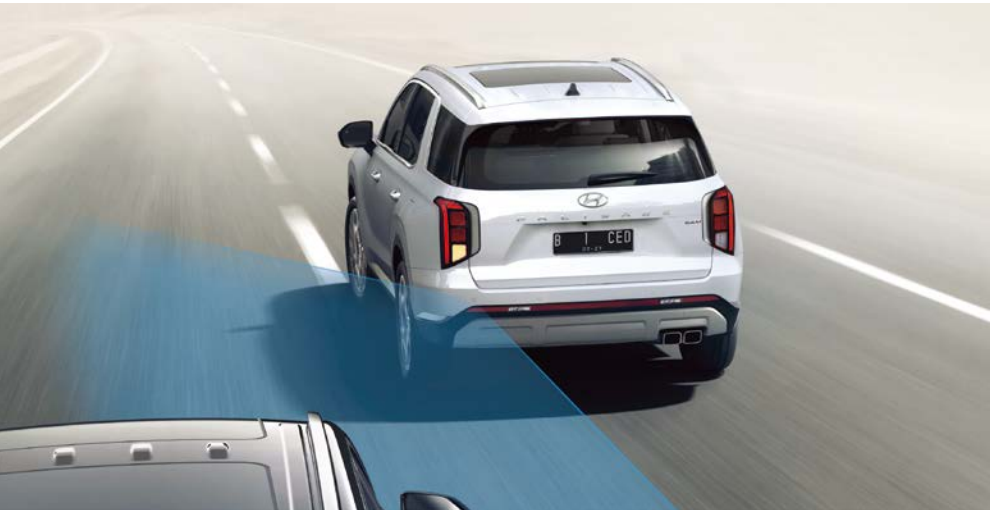
Blind spot Collision Warning (BCW)* Sensor radar di bumper belakang berfungsi untuk memperingatkan pengemudi ketika ada kendaraan yang mendekat dalam area titik buta.
