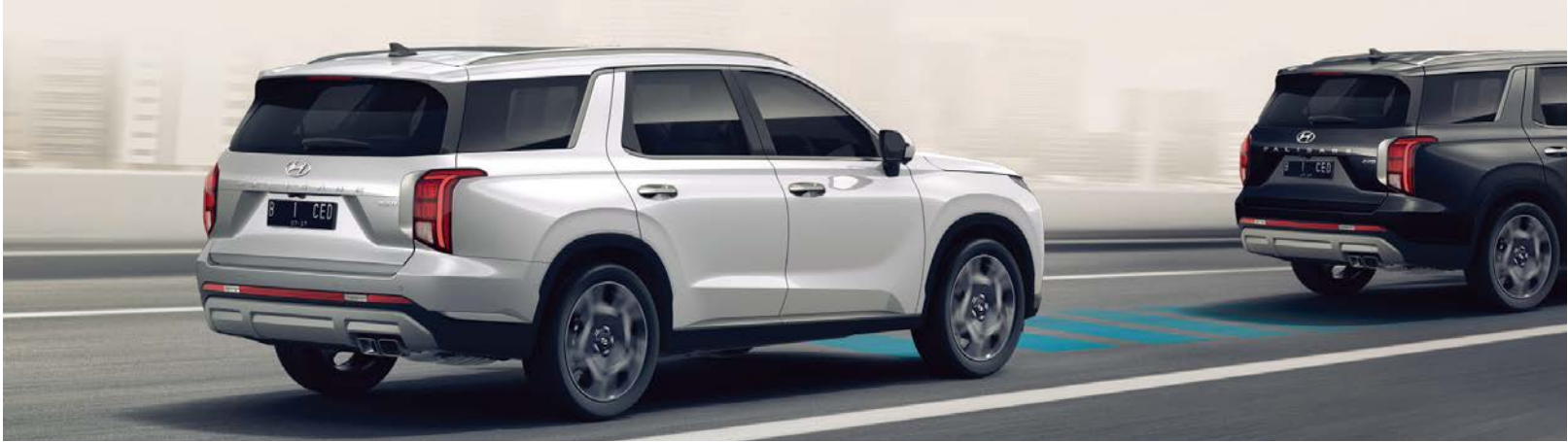
Smart Cruise Control with Stop & Go Function (SCC w/ S&G)* Mengatur kecepatan kendaraan tanpa harus menginjak pedal gas yang secara otomatis dapat menyesuaikan jarak kendaraan di depannya. Apabila kendaraan di depan berhenti, SCC akan secara otomatis mengurangi kecepatan sampai berhenti, dan akan kembali melaju mengikuti kendaraan di depan.
