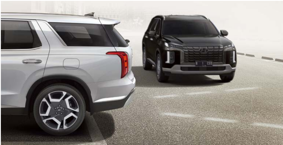
Rear Cross-traffic Collision-avoidance Assist (RCCA)* RCCA memperingatkan apabila ada kendaraan di jalur belakang yang mendekat pada saat mundur dan melakukan pengereman darurat jika diperlukan.
